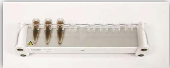
d. Inclinare lentamente l'apparecchio combinato di 90° verso di sé mentre continua ad appoggiarsi sulla superficie, in modo che sia completamente in posizione verticale e i tubi siano rivolti verso di sé.
