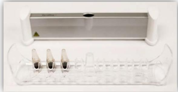
b. Capovolgere la base magnetica Dynamag e abbassarla sul rack trasparente.
